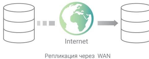
QReplica 2.0 использует iSCSI соединения для механизма репликации. Можно использовать всю пропускную способность сетевого порта для достижения оптимальной скорости копирования. Однако, если требуется зарезервировать часть пропускной способности для других задач, скорость репликации можно ограничить при помощи Traffic Shaping.
